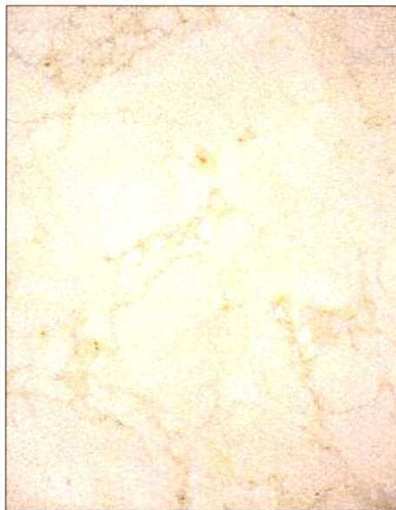
Foto 13. Detalle de una muestra pulida de Crema Marfil Sierra de la Puerta.
