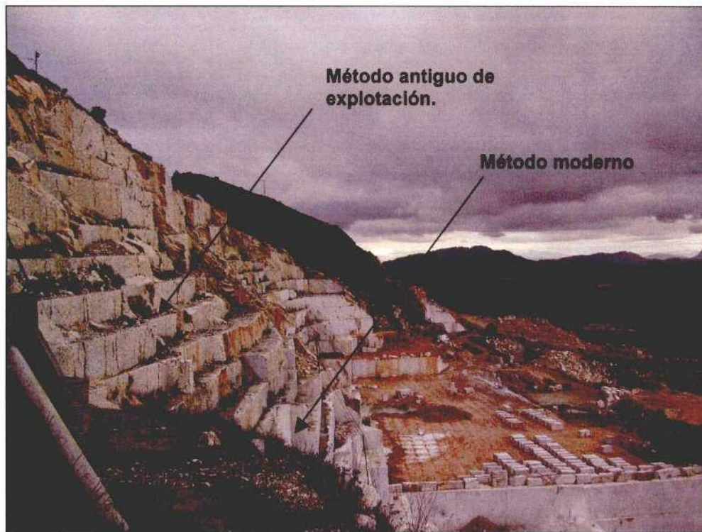
Foto 16. Detalle de una de algunas de las explotaciones en la Sierra de la Puerta, donde se observan los diferentes métodos de explotación de la Roca Ornamental. En la zona superior (parte izquierda de la foto la extracción era mediante hilo helicoidal y barrenos) y en la zona inferior (parte derecha de la foto mediante hilo diamantado).
